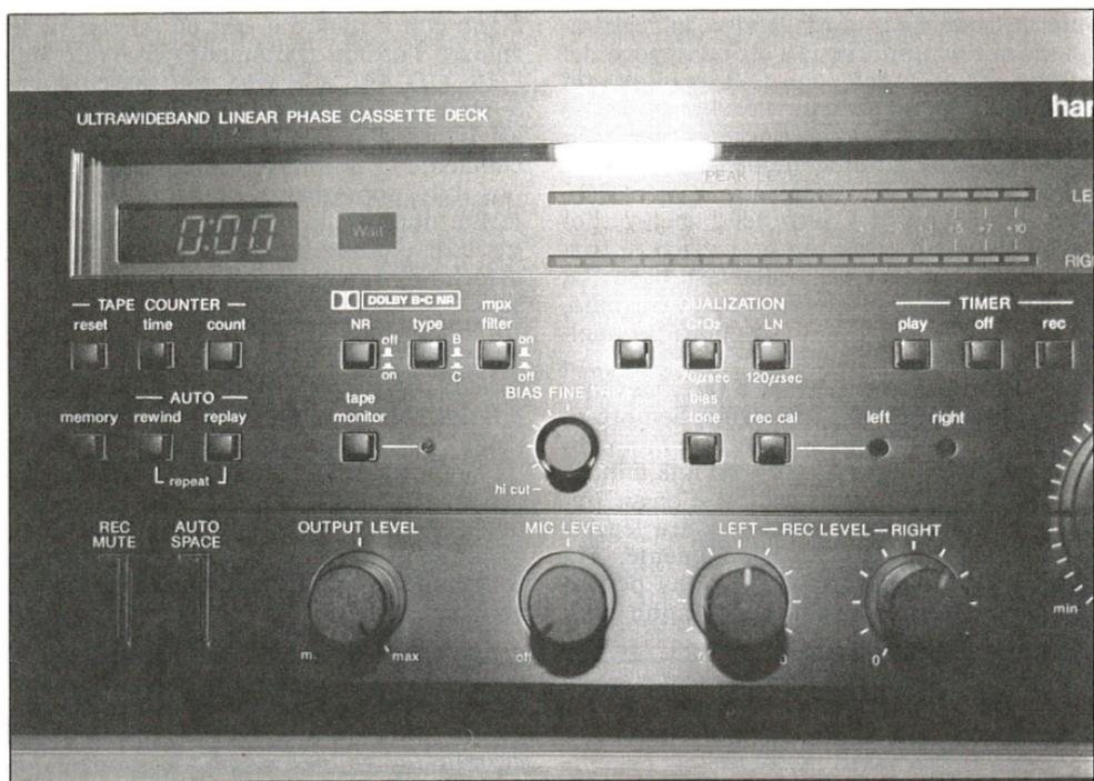
Una parte della sezione funzioni del versatissimo CD 491. Una miriade di tastini ma un'ottima ergonomia.
